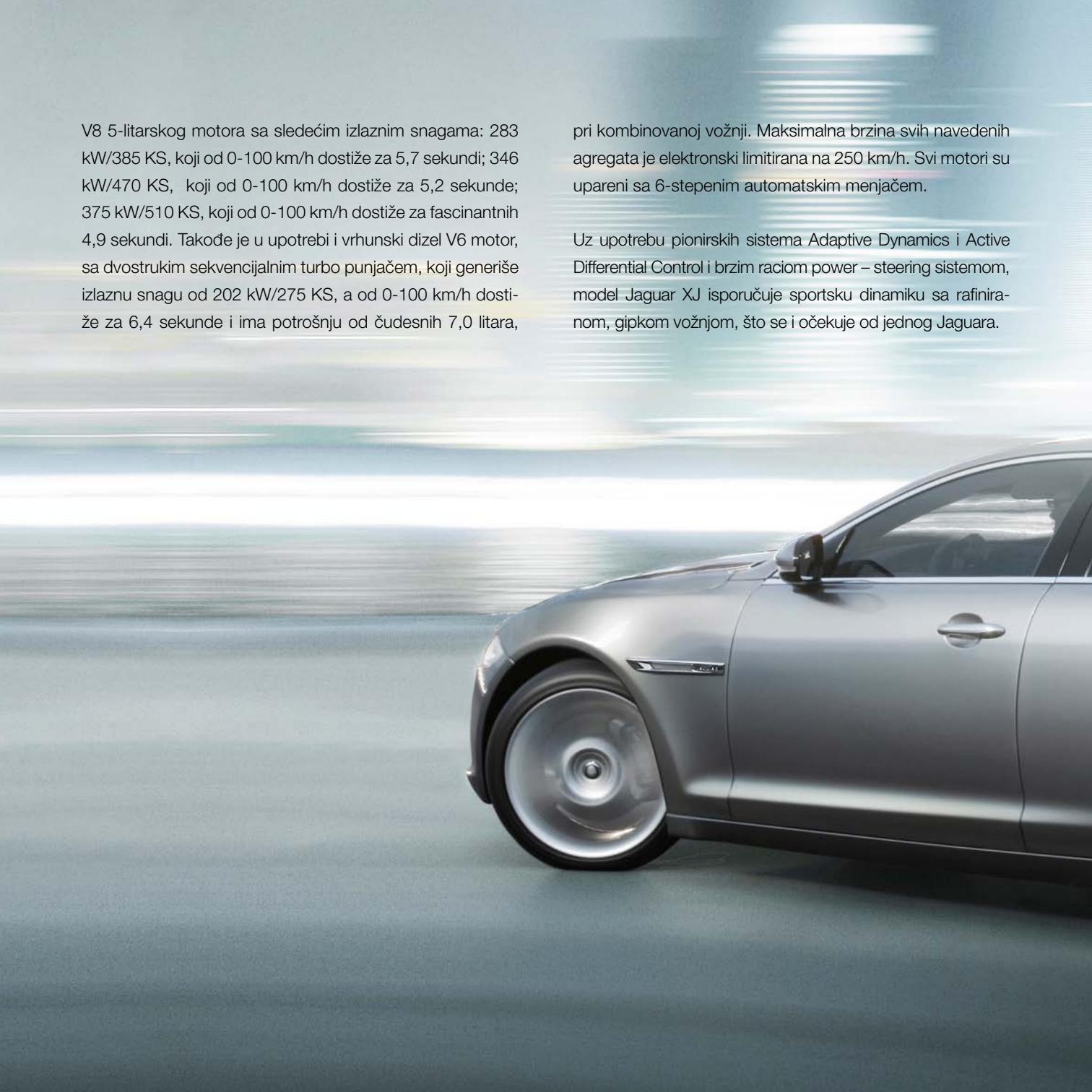
V8 5-litarskog motora sa sledećim izlaznim snagama: 283 kW/385 KS, koji od 0-100 km/h dostiže za 5,7 sekundi; 346 kW/470 KS, koji od 0-100 km/h dostiže za 5,2 sekunde; 375 kW/510 KS, koji od 0-100 km/h dostiže za fascinantnih 4,9 sekundi. Takođe je u upotrebi i vrhunski dizel V6 motor, sa dvostrukim sekvencijalnim turbo punjačem, koji generiše izlaznu snagu od 202 kW/275 KS, a od 0-100 km/h dostiže za 6,4 sekunde i ima potrošnju od čudesnih 7,0 litara,
